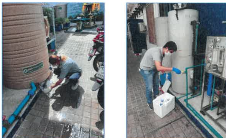
ภาพถ่ายที่ 3.4.3-1 การตรวจวัดคุณภาพน้ำใช้จากก๊อกน้ำที่ผ่านการกรองแล้ว
